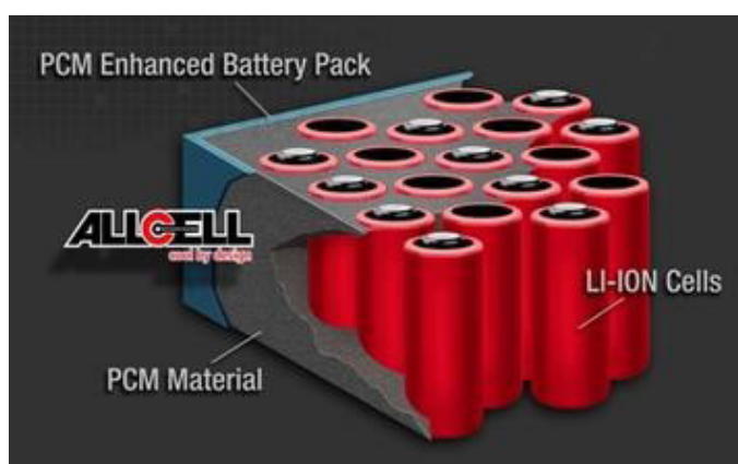
شکل ۲۰ پک‌های باتری تولید شده توسط شرکت AllCell technologies [۷۰]
