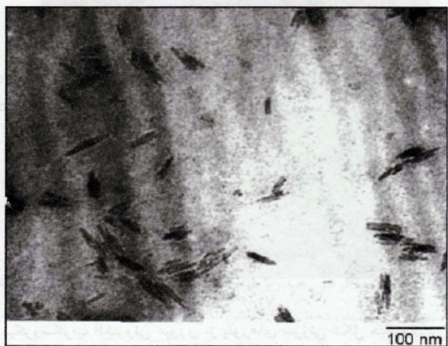
شکل ۹ تصویر میکروسکوپ الکترونی عبوری از نانوذرات هیدروکسی آپاتیت حاصل از رسوبدهی شیمیایی تر [۲۸].
